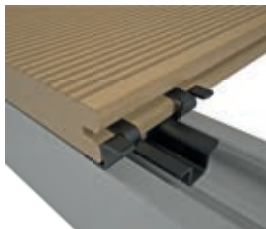
Art.-Nr. 9365/9467 Montageclip für Terrace Massive und Terrace Massive Pro passend für alle Alu-Trägerprofile, drehbar, muss immer verschraubt werden
